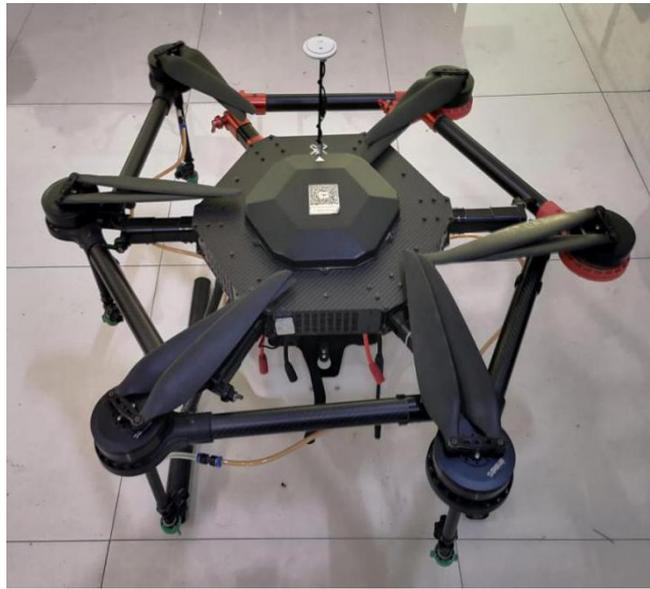
4.5.2 JF-J1650----六轴，15L 载药量，A、B 点任务规划，满载航时 7-10min，最大起飞重量 32kg。
