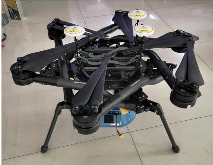
4.5.4 JF-1200----六轴，垂直式起降，pix 地面站航线规划，最大航时 40min ，遥控距离 1—1.5 km ，抗风等级 6 级。
