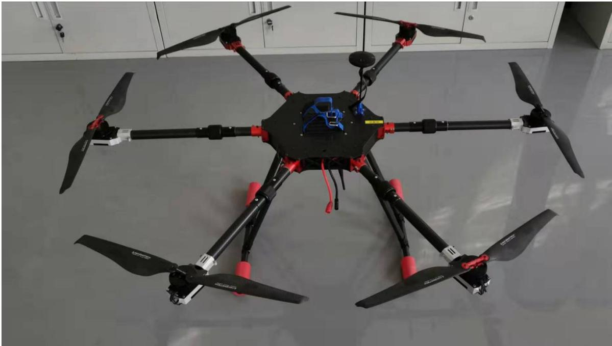
4.5.5 JF-X800----四轴，共轴双桨 X 布局，垂直式起降，大疆 A3 飞控，最大航时 40min，遥控距离 1km，抗风等级 5 级。
