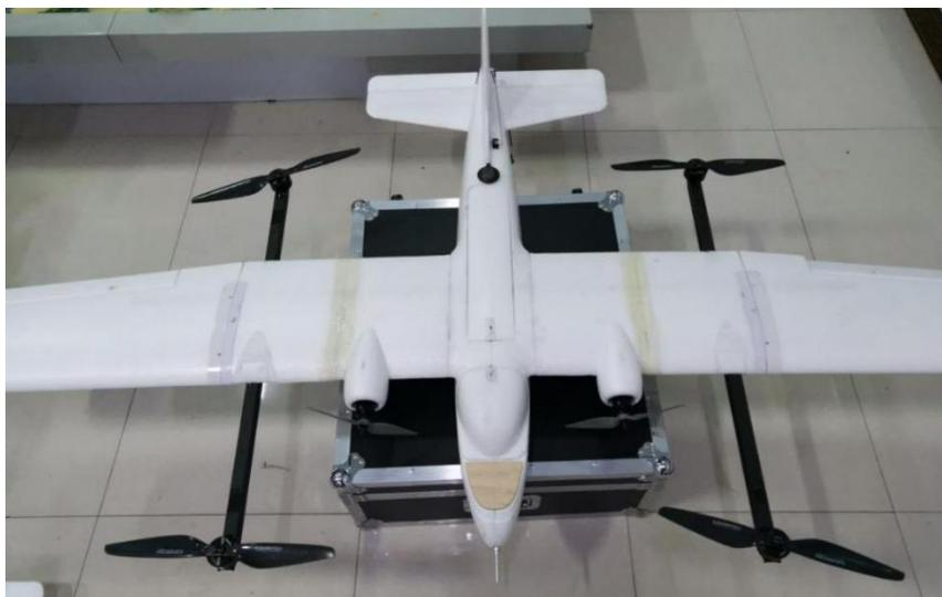
4.5.8 JF-C2200----双子星机架，垂直式起降，最大起飞重量 11kg, 最大航时 1.5h, 巡航速度 20m/s, 搭载 sony-A6000、A7R 相机，30km 数图一体链路，1km 遥控链路。
