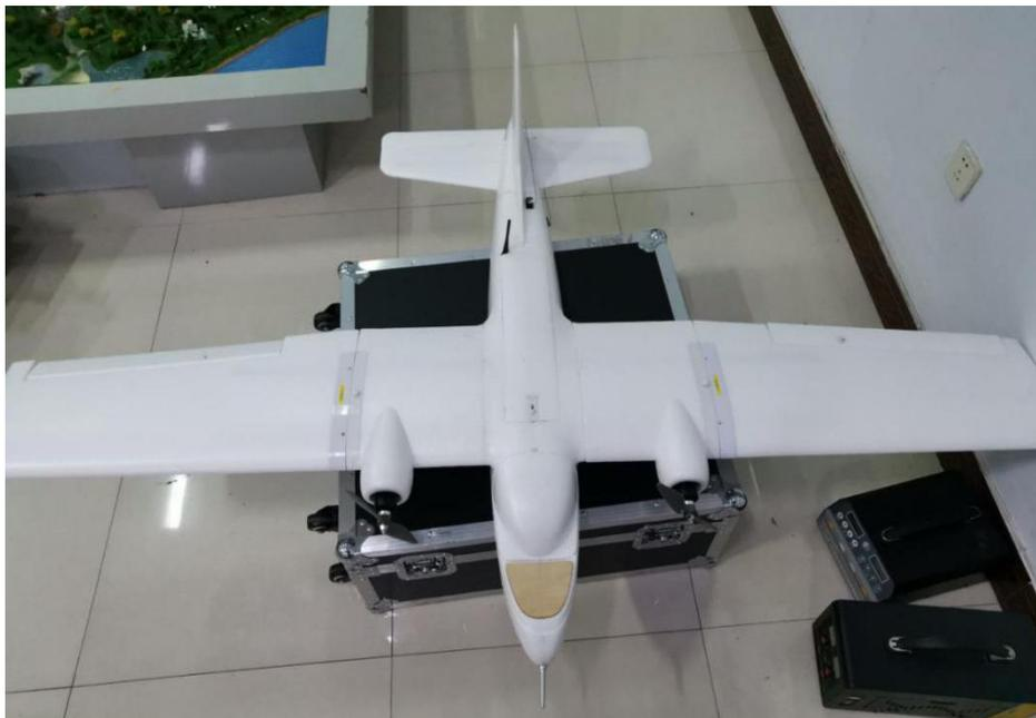
4.5.7 JF-C1800----双子星机架，垂直式起降，最大起飞重量 9kg, 最大航时 1.5h, 巡航速度 20m/s, 搭载 sony-A6000、A7R 相机，15km 数传链路, 1km 遥控链路。
